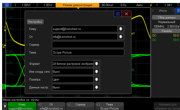
Рисунок 4 С помощью опционального модуля LAN/VGA вы можете отправить E-mail с параметрами, данными, скриншотами.
